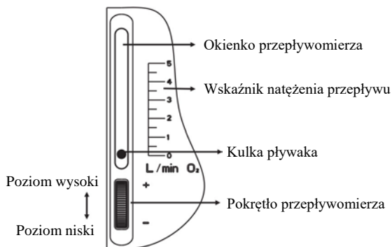
Rys. 6: Ustawianie natężenia przepływu
